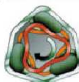
Detalle amortiguación por barras de caucho
